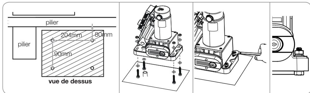
Assurez vous bien que le moteur est horizontal. Insérer des rondelles entre la fondation et l'écrou inférieur si nécessaire. Puis serrer le. Enfin, serrer l'écrou supérieur.
