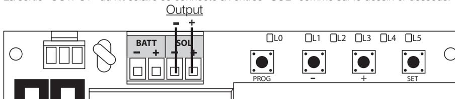
1. Connecter la motorisation au bornier «OUTPUT» en utilisant un câble 2x1.5mm<sup>2</sup>, de longueur ne dépassant pas 2m. Si la longueur de câble nécessaire au raccordement est supérieure à 2m, utiliser du câble 2x2.5mm<sup>2</sup>.
