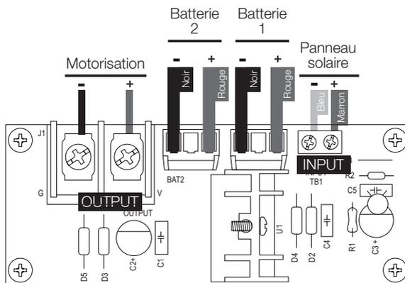
2. Connecter le panneau solaire au bornier vert «INPUT». Respecter la polarité en suivant scrupuleusement le schéma de branchement.
