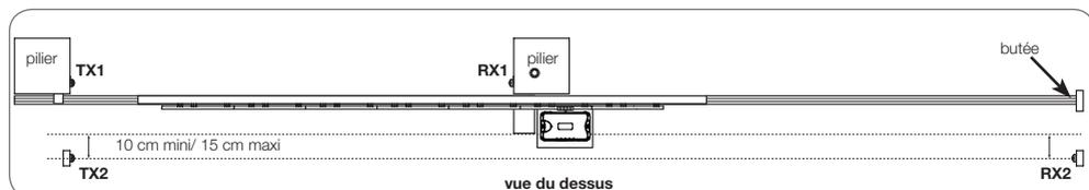
En branchant les photocellules de cette manière, le système réagit à une coupure de l'un ou l'autre des faisceaux infrarouges pendant la fermeture, et du faisceau bord secondaire en ouverture.
