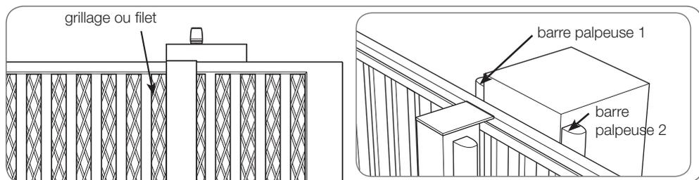
La barre palpeuse 2 est nécessaire si le pilier et le muret (ou clôture) ne sont pas alignés (comme sur le schéma) créant ainsi une zone d'écrasement entre le bord du pilier et un barreau du portail (les barres palpeuses utilisées doivent avoir une déformation suffisante entre le déclenchement et la position où le portail s'arrête effectivement (6 cm) (course résiduelle d'après la figure 3 de la EN 12978).
