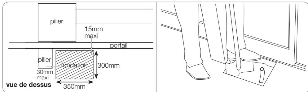
Placez la gaine de passage de câble comme indiqué sur le schéma ci-dessous avant de couler le béton.
