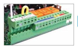
Afin de faciliter le branchement les borniers sont démontables.
