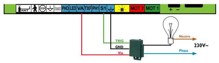
Commande pour l'éclairage de la zone couverte par le mouvement du portail. Temporisation non réglable de 60 secondes. Ce module doit être obligatoirement installé dans un coffre électrique de classe II, IP44.
