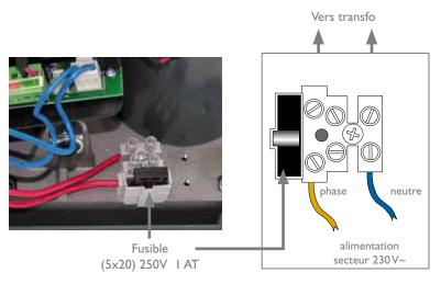
L'alimentation, une fois protégée par un disjoncteur bipolaire 10A et un interrupteur différentiel de 30 mA, se raccorde sur le bornier à l'intérieur du bloc moteur contenant l'électronique.
