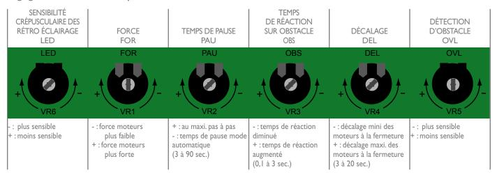
Le trimmer VR 2 (PAU) permet non seulement de régler le temps de pause avant la fermeture automatique, il permet également de configurer le fonctionnement de votre motorisation en mode « pas à pas » en le positionnant au maxi. vers le +.
