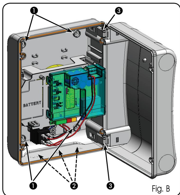
Les charnières du couvercle peuvent coulisser vers le haut pour permettre l'ouverture du coffret (Fig.C); on peut également les démonter et les remettre en place pour obtenir une ouverture du couvercle vers la droite ou vers la gauche.
