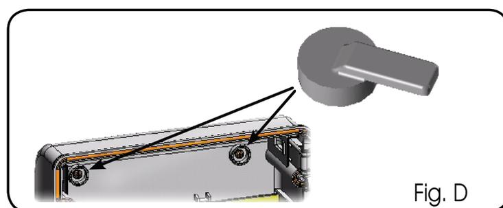
Au terme des opérations de connexion de la platine électronique aux différentes parties de l'automatisme, fermer le coffret en positionnant le couvercle dans le logement avec le joint prévu à cet effet. Brancher l'alimentation come indiqué dans la Fig. E.
