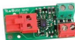
**Interface BUS XIB pour branchement cellules non Bus (avec E024S uniquement)**
