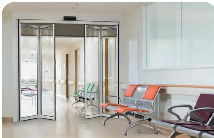
**INDIQUÉ POUR LES ENDROITS DANS LESQUELS IL EST IMPOSSIBLE D'INSTALLER DES PORTES TRADITIONNELLES À COULISSEMENT LATÉRAL ET OÙ UNE ISSUE DE SECOURS EST NÉCESSAIRE.**
