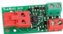
**Interface BUS XIB pour branchement cellules non Bus (avec E024S uniquement)**
