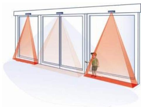
FAAC préconise le radar XDT1 pour la protection en fermeture : Dispositif de commande d'ouverture et sécurité réunies en un seul capteur, Technologie et système BI-Technologie, micro-ondes et infrarouge actif à installer dans l'axe de la porte.
