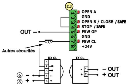
Branchement 1 paire de photocellules en fermeture avec sécurité FAIL-SAFE et STOP **désactivée**
