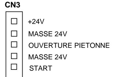
**Si STOP, PHOTOCÉLULE ou SECURITE ne sont pas connectés, ponter les bornes correspondantes ( 3 avec 4, 8 avec 9 - CN4) ( 4 avec 6 - CN5).**
