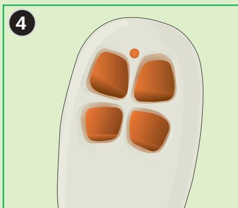
Dans les 10 secondes qui suivent, appuyer sur l'un des boutons de la télécommande à programmer, puis relâcher le bouton.
