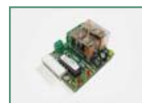
D113050 - SPL Carte de préchauffage pour 1 ou 2 opérateurs mod. LUX, SUB, ORO, P4,5-P7, BERMA et E5. L'automatisme est en mesure de fonctionner à des températures très basses grâce à cet accessoire. 49,40 €
