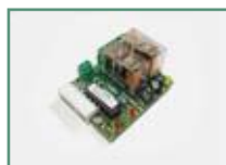
D111704 - SSR5 Carte du feu de circulation et préchauffage pour Unité de commande mod. RIGEL 5. Avec cet accessoire, l'automatisme est en mesure de fonctionner à - 20 °C. 44,00 €
