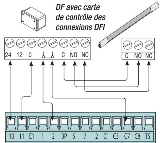
**Contact (N.C.) de «ré-enclenchement de la fermeture pendant l'ouverture»**
