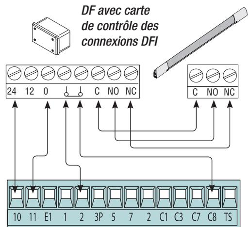
**6.4 Connexion électrique pour le fonctionnement du test de contrôle de sécurité des photocellules****(DOC)**
