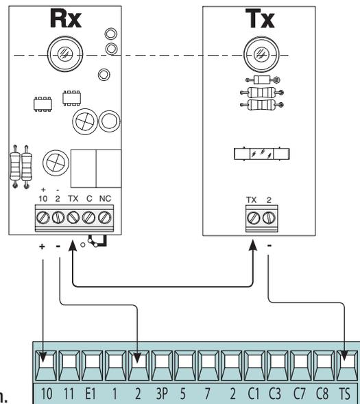
A chaque commande d'ouverture ou de fermeture, la carte contrôle le fonctionnement des photocellules. Une anomalie éventuelle détectée sur les photocellules est signalée par le clignotement de la Led (PROG) sur la carte électronique et elle annule toute commande de l'émetteur radio ou du bouton.
