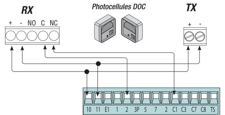
**Contact (N.C.) de «réouverture pendant la fermeture»**
